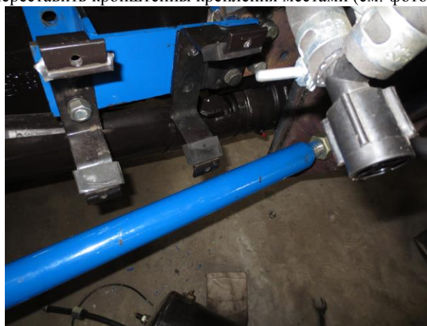
Фото крепления ресивера на МТЗ 82.1 с усил. мостом
